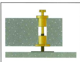
コンクリート二次製品は、マルチレベル治具 の形状と製品自重によりスライドベース上に しっかりと固定されます。マルチレベル治具 は工場出荷時や現場にて取り付けることも自 由自在です。
