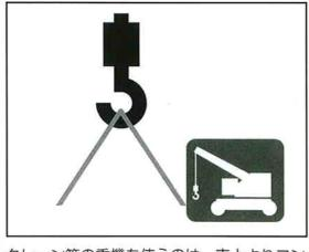
クレーン等の重機を使うのは、車上よりコン クリート二次製品を基礎コンクリートにあら かじめ設置されたスライドベース上に降ろす 時だけです。
